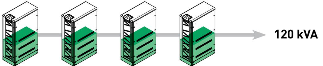
**REEQUILIBRADO AUTOMÁTICO DE LA CARGA EN CASO DE MANTENIMIENTO**
