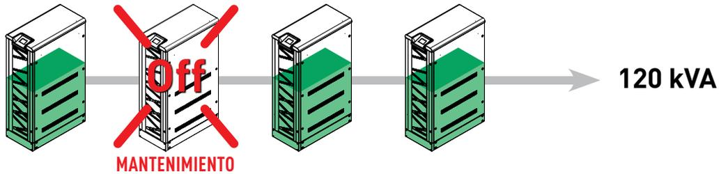
**EQUILIBRADO AUTOMÁTICO DE LA CARGA MÁXIMA EN CASO DE INTERRUPCIÓN DURANTE EL MANTENIMIENTO**
